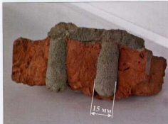
Рис. 1. Взаимодействие раствора и пустотелого кирпича
